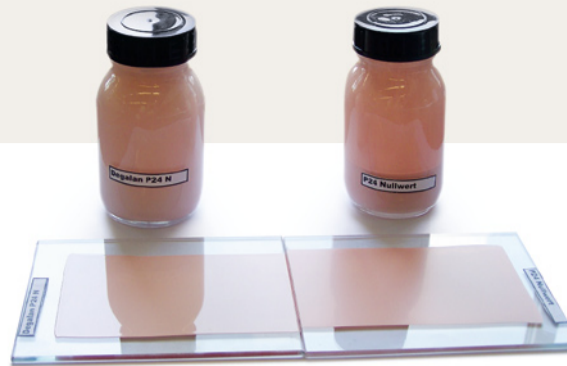
Abbildung 1: Filme pigmentierter Bindemittel; links: Formulierung 1 mit kontinuierlich hergestelltem Produkt; rechts: Formulierung 2 mit Suspensionspolymerisat
