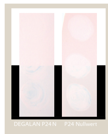
Abbildung 2: Rub Out-Test; Formulierungen identisch zu Abbildung 1; links: Formulierung 1 mit kontinuierlich hergestelltem Bindemittel; rechts: Formulierung 2 mit Suspensionspolymerisat
